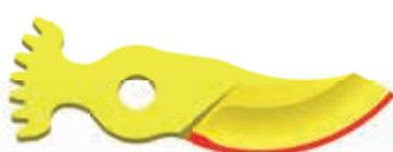
Se l'affilatura viene effettuata solo sul taglio, dopo alcune volte la parte sottile della lama scompare e si perderà l'angolo di attacco.
